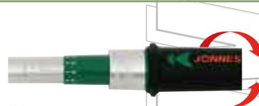
3. Заблокировать регулировочный механизм, нажав на фиксатор блокировки в направлении, показанном на рисунке.
