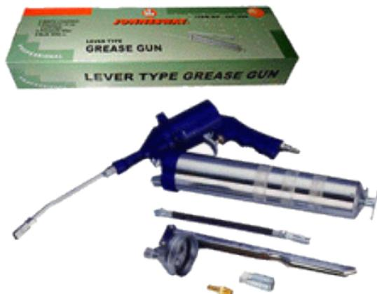
Пневматический нагнетатель консистентных смазок **JONNESWAY JAT- 6004K** применяется для проведения регламентных и ремонтных работ по смазке узлов и механизмов автомобилей и машин, снабженных пресс-масленками с внешним конусом от 4 до 10 мм. в цехах и мастерских, оборудованных пневматической линией с номинальным давлением не менее 6 Атм.
